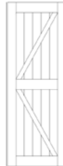
1 zijde planken - 1 zijde kader 1 côté planchettes - 1 côté cadre
